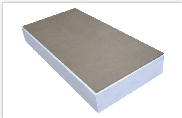
Austrotherm PADLAP – styropianowe płyty Austrotherm EPS 037 DACH/PODŁOGA trwale pokryte od strony zewnętrznej wiórową płytą MDF o grubości 6 mm. Przeznaczone do samodzielnej termoizolacji stropu poddasza nieużytkowego w budynkach jednorodzinnych.
